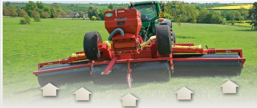
Die mittig aufgehängten Seitensegmente werden freie Beweglichkeit im Verhältnis zu dem Mittelteil durch die Tragarme/Flügel der Seitensegmente sichergestellt. Gleichzeitig kann der Mittelteil dem Boden unabhängig vom Schlepper anpassen, da die Deichsel mit drehbarer Zugöse ausgerüstet ist. All dies macht die 3 Walzensegmente im Verhältnis zu der Oberfläche des Ackers völlig flexibel.
