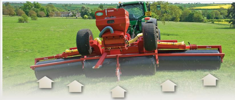
Les pivots centraux des sections latérales, les deux pivots de repliement et l'œil tournant du timon d'attelage permettent le suivi de terrain pour chacune des 3 sections Grass-Roller indépendamment l'une de l'autre.
