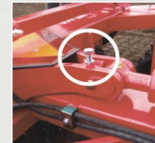
Die Anhänghöhe läßt sich mit dem Anschlagbolzen des Kippzylinders einfach korrigieren.
