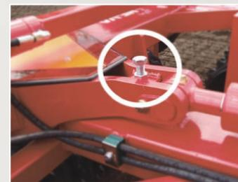
A l'aide d'un simple boulon de réglage, la flèche d'attelage est attelée au tracteur à la hauteur idéal. Les anneaux sont montés sur un arbre de 60 mm en acier traité en rotation sur paliers à triple étanchéité, fixés par 4 boulons et protégés à l'intérieur d'un bras profilé en U.
