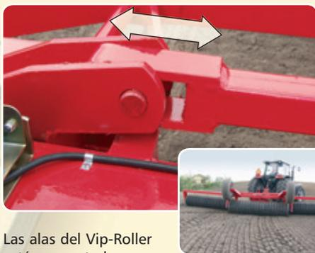
Las alas del Vip-Roller están conectadas a la sección central para girar, de forma controlada, siguiendo la línea de nivel del terreno.
