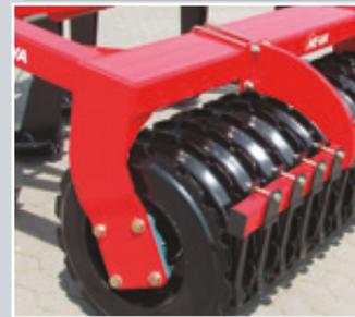
El perfil-V  $\varnothing 600$  mm consiste en de acero prensado con un perfil que asegura una agresiva ruptura un acabado de la superficie perfectamente montadas entre los anillos hacen la preparación del suelo en condiciones pegajosas.
