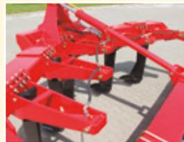
está conectado a dos tanques acumuladores de gas, asegurando el balanceo automático del diente, incluso si éste se pone en contacto con piedras fijas grandes. Este sistema funciona también como un amortiguador en suelos pedregosos, donde atraparé las vibraciones.
