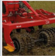
Rodillo estrella 450/500 mm (sin ancho) construido de anillos de acero dejando el terreno plano y suelto.
