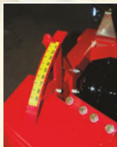
La profundidad de trabajo es controlada de modo exacto mediante el hidráulico del rodillo. Con la escala de profundidad el tractorista puede ver exactamente la profundidad de trabajo actual.
