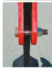
Le Combi-Tiller MKI est protégé contre les surcharges par des boulons de sécurité situés sur les différentes dents.
