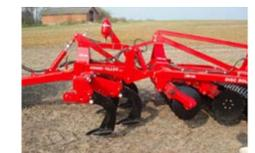
Lorsqu'il est associé à un Disc-Roller, la profondeur de travail des dents peut être réglée de 50 mm au-dessus du sol jusqu'à une profondeur de travail maximale de 400 mm.
