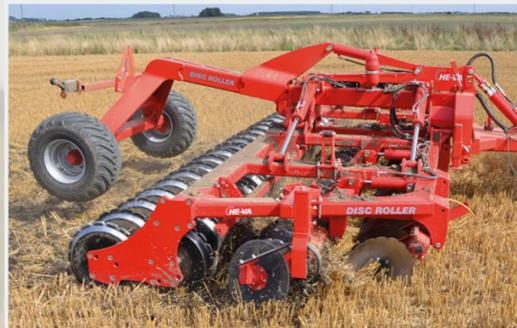
Oder Bearbeitung von gepflügtem Boden vor der Aussaat. Mit rund 1 Tonne pro Meter haben Sie hier eine effiziente Verdichtungspressen für die zweite Bodenbearbeitung.
