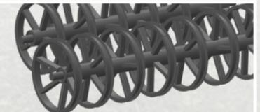
Eine Twin-Walze ist eine gute, wartungsfreie Lösung, da sich die Walzen während der Fahrt gegenseitig reinigen. Die Twin U-Profilwalze bietet eine gute Boden-zu-Boden-Verdichtung ohne zu glätten.
