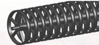
Die U-Profilwalze ist so ausgelegt, dass die Walze während der Fahrt mit Erde gefüllt wird und man somit eine gute Boden-zu-Boden-Verdichtung bekommt und die Bodenoberfläche eine natürliche Struktur ohne zu glätten erhält.
