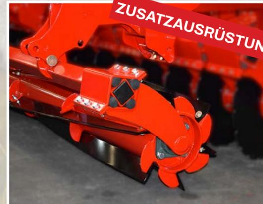
Die Montage einer Top-Cutter-Messerwalze vor den Scheiben Ihres Disc-Roller Classic ermöglicht es Ihnen, Pflanzenrückstände fein zu zerkleinern und einzuarbeiten.
