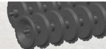
Eine Twin-Walze ist eine gute, wartungsfreie Lösung, da sich die Walzen während der Fahrt gegenseitig reinigen. Die V-Profil Twin-Walze hinterlässt eine leicht wellenförmige Bodenoberfläche, was eine Drainagewirkung hat und zu schnellerer Erwärmung und Trocknung beiträgt.
