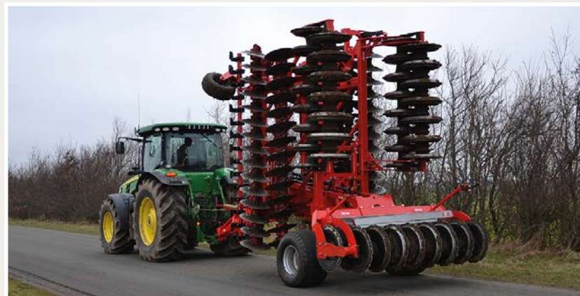
Disco Roller XL Contour con 2 sezioni di dischi e 3 sezioni di rulli in posizione di trasporto (6,5 + 7,5 m)
