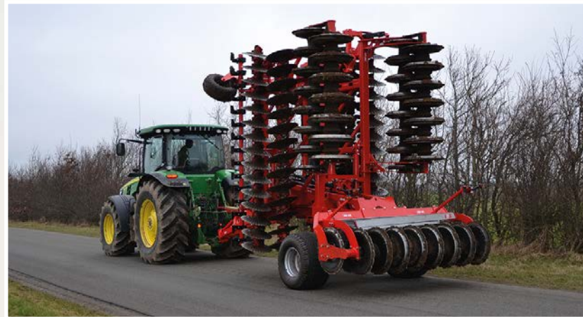
Disc-Roller XL Contour sa dvosmislenim diskom i trodelnim valjkom u transportnoj poziciji (6,50 + 7,50 m)
