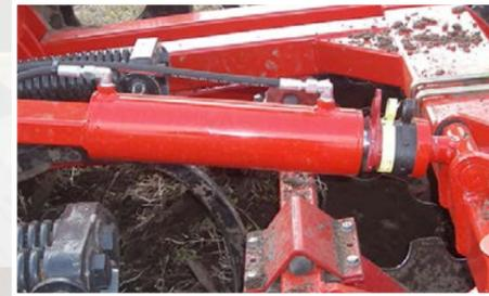
Bei allen Triple-Tiller-Modellen erfolgt die Tiefenregulierung hydraulisch von der Kabine aus mit der Option von festen Stopps durch die Montage von Distanzclips auf den Tiefenzylindern.
