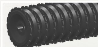
Rullo Ø600 mm con un'azione di taglio ottimale che lascia un consolidamento ideale e, soprattutto, una superficie resistente alle intemperie. Il profilo a V è un anello a corona dentato in acciaio stampato con profilo a spalla che consente una frantumazione aggressiva della zolla in terreni pesanti e un consolidamento uniforme in terreni più leggeri. I raschiatori regolabili tra ogni anello assicurano un efficace consolidamento del terreno in tutte le condizioni.
