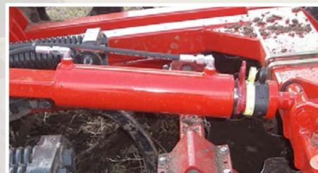
Su tutti i modelli la profondità di lavoro è regolata idraulicamente dalla cabina con possibilità di fermo fisso tramite le clips distanziali. Sono incluse clips di diverse dimensioni, che consentono all'utente di raggiungere la giusta profondità.
