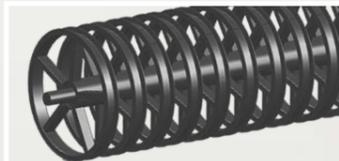
Il rullo con profilo a U è progettato perché il canale dell'anello si riempia di terra durante la lavorazione, per assicurare un buon consolidamento e dare alla superficie una tessitura naturale senza deriva.
