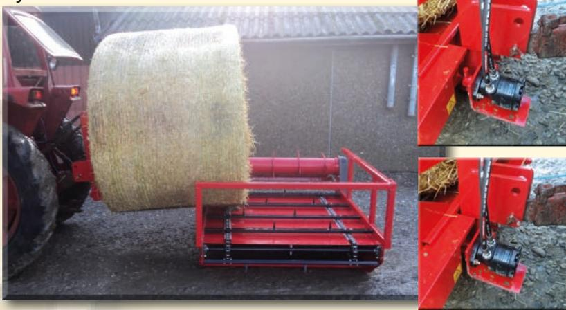
Uno de los rasgos únicos de la máquina es la doble punta por listón. Esta permite cargar la paca redonda sobre la plataforma de alimentación. Sin que el tractorista necesite dejar su asiento, la paca puede ser acoplada a la plataforma de alimentación.
