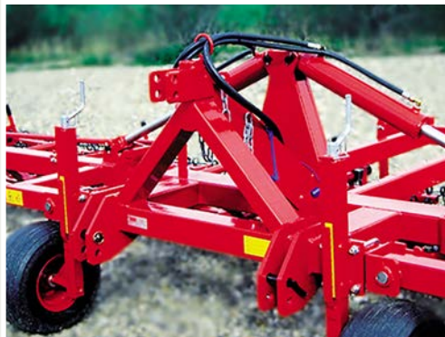
Das Kopplungssystem bei 9,00 low, 12,00 und 15,00 m Modellen
