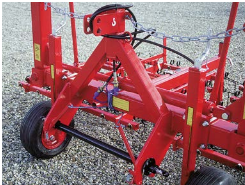
Das Kopplungssystem bei 6,00, 7,50 und 9,00 m Modellen.
