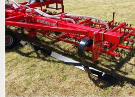
Der Weeder HD kann wahlweise mit 9mm oder 7mm starken Zinken ausgerüstet werden, wobei auch beide Zinkenstärken kombiniert genutzt werden können. Da der Zinkenwechsel durch ein Stecksystem werkzeuglos erfolgt, kann der Strigle einfach von 9mm auf 7mm Zinken umgerüstet werden. Dadurch ergibt sich die Möglichkeit, das Gerät sowohl als Grünland- wie auch als Ackerpflegestriegel zu nutzen.
