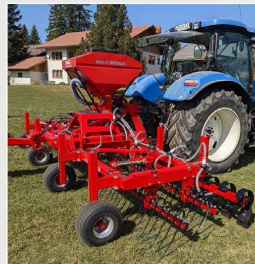
Der standardmäßig verbauter rückwärtiger Koppelbock bietet zudem die Möglichkeit, den Grass-Combi in Kombination mit einer gezogenen Walze zu nutzen. Hier bietet sich der HE-VA Tip-Roller als optimale Ergänzung an.
