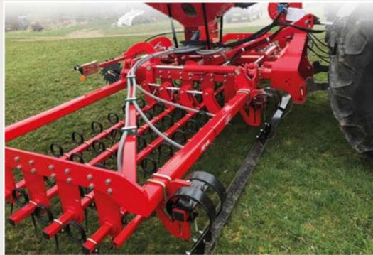
Als Einebnungswerkzeuge stehen dem Kunden entweder eine Planierschiene oder das Spring-Board zur Verfügung. Sowohl Planierschiene als Springboard sind in der Höhe verstellbar.
