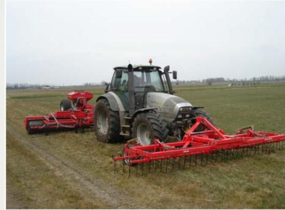
Der HE-VA Top-Strigle kommt serienmäßig mit einer hydraulischen Zinkendruckverstellung, zudem kann der Winkel der einzelnen Zinkenreihen zueinander mechanisch verstellt werden, welches eine optimale Einstellung des Striegels ermöglicht.
