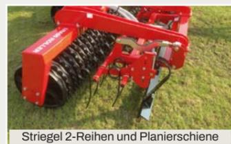
Striegel 2-Reihen und Planierschiene
