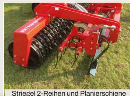
Striegel 2-Reihen und Planierschiene
