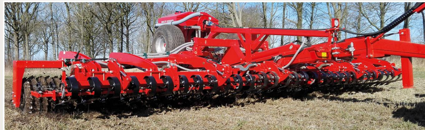
Durch das SAT-System verfügt der Grass-Roller über eine optimale Gewichtsverteilung, zudem entsteht durch die pendelnd aufgehängten Seitensektionen eine herausragende Boden Anpassung – entscheidend gerade im kupierten Gelände.
