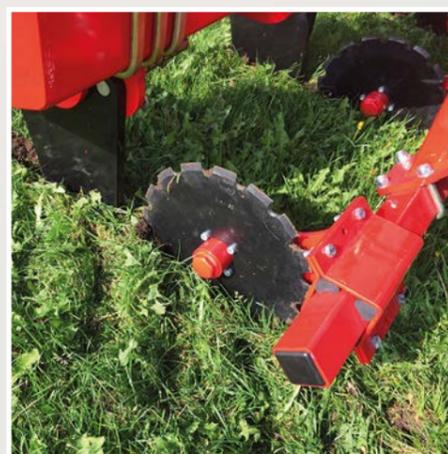
Die Tiefenführung über die Nachlaufwalze wird serienmäßig hydraulisch eingestellt und als Zinkensicherungssystem stehen Multiabscherbolzen oder hydraulische Überlastsicherung zur Verfügung.
