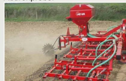
Je nach Arbeitsbreite, Saatgut u. -menge kann ein elektrisches oder hydraulisches Gebläse genutzt werden, wodurch ein problemloses Arbeiten jederzeit gewährleistet ist.
