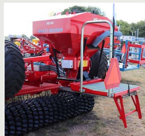
HE-VA Multi-Seeder est un semoir pneumatique pour petites graines, adaptable sur plusieurs machines HE-VA.
