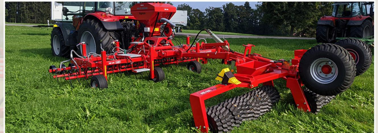
Le roulage en Printemps des prairies rendues inégales à cause du gel hivernal est inévitable. Le rouleau appuie uniformément, rétablissant le sol, nivelle les irrégularités, et enfonce les pierres solides. Un anneau Etoile avec profil spécial HE-VA brise le sol et procure un bon effet de drainage.
