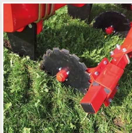
Le contrôle hydraulique de profondeur est standard via le rouleau, ainsi que la sécurité de pierres par boulons Quick-Push ou par nonstop hydraulique automatique.
