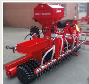
HE-VA Grass-Seeder est la solution économique et compacte pour l'entretien des prairies. Une évolution du rouleau éprouvé Lift-Roller, le Grass-Seeder peut être combiné avec les dents de hersage et un rouleau Lisse – complété par le semoir pneumatique HE-VA Multi-Seeder.
