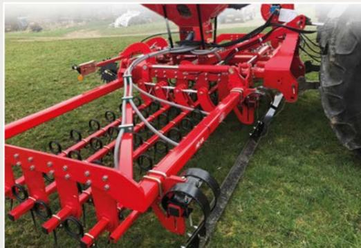
Pour le nivellement, l'utilisateur peut choisir une des options lame niveleuse ou Spring-Board, les deux avec hauteur réglable.
