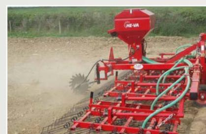
En fonction de largeur de travail, de type de semence et des quantités, la turbine électrique ou hydraulique assure la tâche accomplie sans soucis.
