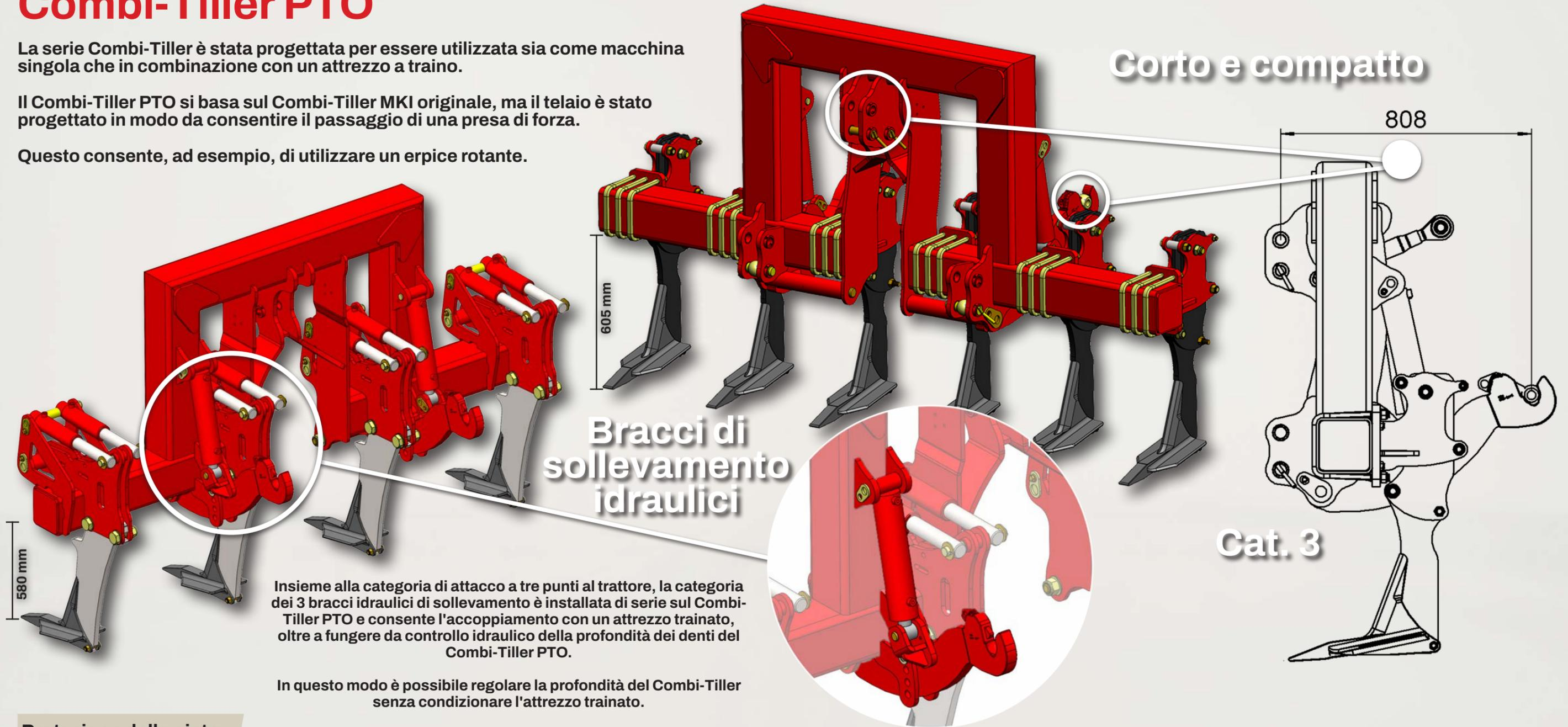
Insieme alla categoria di attacco a tre punti al trattore, la categoria dei 3 bracci idraulici di sollevamento è installata di serie sul Combi-Tiller PTO e consente l'accoppiamento con un attrezzo trainato, oltre a fungere da controllo idraulico della profondità dei denti del Combi-Tiller PTO.
