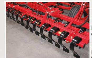
Montando una livella Spring-Board davanti all'erpice Euro-Tiller, il campo viene livellato perfettamente e le zolle principali vengono rotte. Il dente dello Spring-Board è una robusta molla da 10 x 80 mm, equipaggiata di serie con punta da 8 x 150 mm. La Spring-Board ha la regolazione idraulica della profondità di lavoro/aggressività, che può essere regolata durante il funzionamento.
