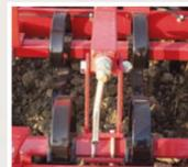
La livella posteriore Spring-Board è collegata alla barra di livellamento anteriore Spring board, il tutto è regolato idraulicamente. Le livelle anteriori e posteriori sono regolabili indipendentemente attraverso la barra di collegamento.
