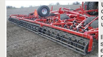
Un rullo a lame da Ø400 mm con davanti montato il post-erpice a denti lunghi lascia una superficie consolidata e frantumata. Con la sua costruzione in acciaio piatto da 8 x 40 mm, questo tipo di rullo garantisce una perfetta struttura del terreno.
