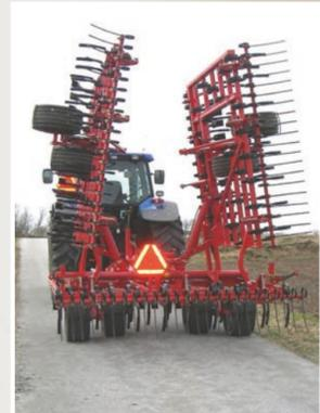
Durante il trasporto le sezioni laterali vengono ripiegate in posizione verticale per ottenere un trasporto sicuro e stabile. Un robusto blocco meccanico garantisce il trasporto sicuro di tutte le unità e lo sblocco automatico avviene tramite l'impianto idraulico. I robusti supporti a cerniera delle sezioni laterali garantiscono anche un'elevata resistenza, quando l'erpice è in posizione di lavoro.
