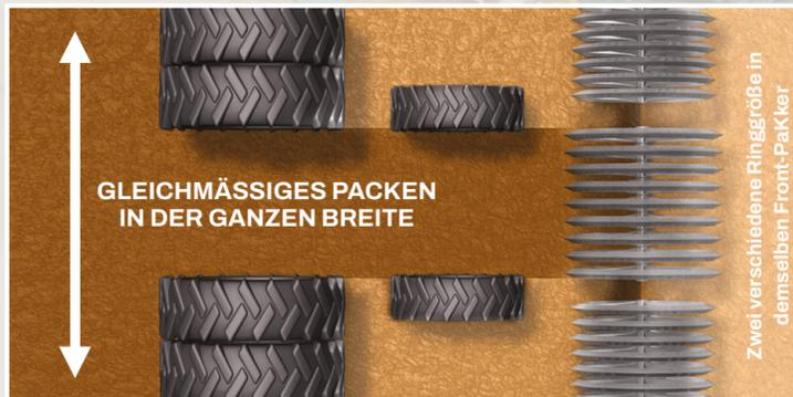
Mit 700 mm und 800 mm Ringen wird auf leichtem, mittelschwerem und schwerem Boden ein gutes und vielseitiges Arbeitsergebnis erreicht – die Ringe haben aufgrund des Verhältnisses zwischen Gewicht und Durchmesser und wegen des Schulterprofils einen geringen Rollwiderstand.
