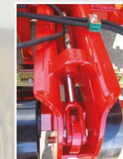
An allen Maschinen mit Spring-Board ist der Arbeitswinkel der Schleppzinken während der Fahrt hydraulisch verstellbar, und die Schleppzinken lassen sich nach Bedarf ganz anheben. Die Skala, die vom Schleppersitz sichtbar ist, zeigt den
