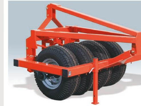
Der HE-VA Press-Roller ist ein Reifenpacker mit Selbstlenkung. Er ist eine gute Lösung wenn die gleiche Rückverfestigung sowohl zwischen den Schlepperrädern als hinter den Schlepperrädern gewünscht wird. Das 4,00 m Gerät hat ein Rad an den beiden Seiten außerhalb der Schlepperspuren. Der Press-Roller ist ein Reifenpacker mit Selbstlenkung. Die Räder des Press-Rollers sind auf einer 60 mm Welle montiert.
