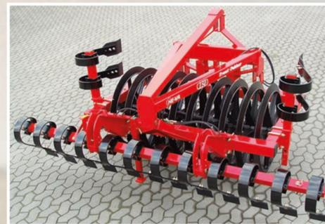
Schleppers, und die Räder/ Zwillingräder des Schleppers sichern eine Rückverfestigung der restlichen Arbeitsbreite. Das 4 m Spring-Board für den 1,65 m Front-Pakker lässt sich mechanische auf eine Transportbreite von 2,85 m umstellen.
