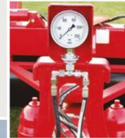
Le report de poids s'effectue sur les deux sections intermédiaires (O) voir photo. Le système S.A.T. permet d'uniformiser la pression au sol aussi bien sur la section centrale que sur les sections intermédiaires et extérieures.
