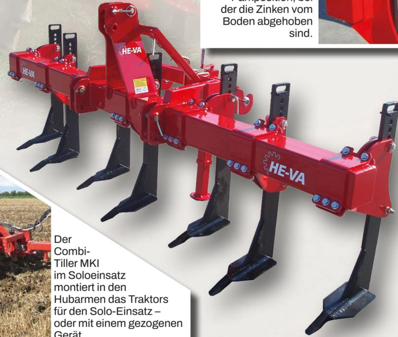
Der Combi-Tiller MKI im Soloeinsatz montiert in den Hubarmen des Traktors für den Solo-Einsatz – oder mit einem gezogenen Gerät...
