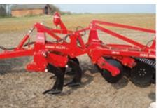
In Verbindung mit einem Disc-Roller kann die Arbeitstiefe der Zinken von 50 mm über der Erdoberfläche bis zu einer Arbeitstiefe von 400 mm eingestellt werden.
