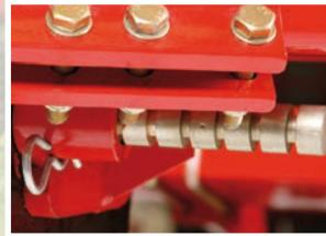
Auf leichten Böden mit wenig Steinen ist die Quick-Push-Steinsicherung die beste Wahl. Diese ist eine Weiterentwicklung des herkömmlichen Scherbolzen. Anstatt nach jedem Auslösen einen neuen Bolzen verwenden zu müssen, stehen dem Landwirt hier 8 Auslösungen pro Bolzen zur Verfügung.
