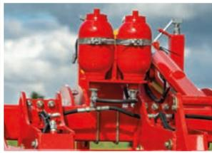
Der Grass-Tiller ist mit hydraulischer oder Quick-Push-Scherbolzenzinkensicherung erhältlich. Auf schweren und steinig Standorten ist die hydraulische Steinsicherung die beste Option. Nach dem Auslösen fährt der Zinken selbsttätig wieder in die Ausgangsposition.
