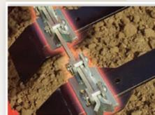
Die optionale Querverriegelung wandelt die einzelnen Zinken in eine zusammenwirkende Planierschiene für besseren Planiereffekt.
