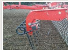
Bei Kultivierung eines abgesetzten Saatbetts kann ein Frontstriegel mit 14 mm Zinken montiert werden, um den Boden oberflächlich zu bewegen.
