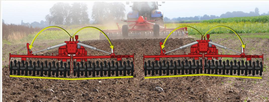
Das hydraulische Faltsystem der Disc-Roller Contour ist mit zwei Akkumulatoren und einem Hydraulikdruckmesser verbunden. Der Druckmesser ermöglicht es dem Bediener, über die Arbeitsbreite für gleichbleibende Bodenbearbeitung zu sorgen. Die Akkumulatoren wirken als Ölpuffer, wenn die Egge über unebenen Boden bewegt wird und die Hydraulikkolben ein- oder ausfahren, um der Scheibenegge zu erlauben, den Konturen zu folgen.
