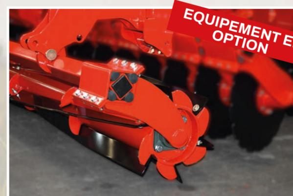
Le montage d'un Top-Cutter devant les disques de votre Disc-Roller Classic vous permet de broyer finement et d'incorporer les résidus végétaux.
