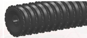
Die V-Profilwalze zerdrückt Erdklumpen sehr effektiv und hinterlässt eine gleichmäßige Bodenoberfläche. Pflanzenreste, Stroh und Stoppeln werden in die Oberfläche gedrückt, wodurch die Zersetzung begünstigt wird.
