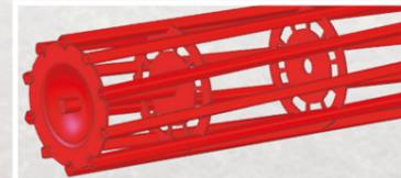
Die schwere Rohrstabwalze mit 550 mm Durchmesser sorgt für eine gute Tiefenführung und zerkleinert Erdklumpen auf leichten, losen Böden.
