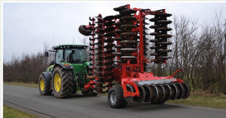
Disc-Roller XL Contour avec disques crénelés
