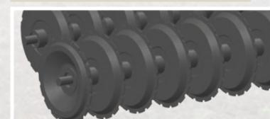
Les rouleaux jumelés constituent une bonne solution d'entretien. Les anneaux disposés en quinconce se nettoient mieux durant le travail. Le rouleau Twin V-profil laisse une surface de sol légèrement ondulée, qui produit un effet drainant et contribue à un réchauffement et à un séchage rapide.
