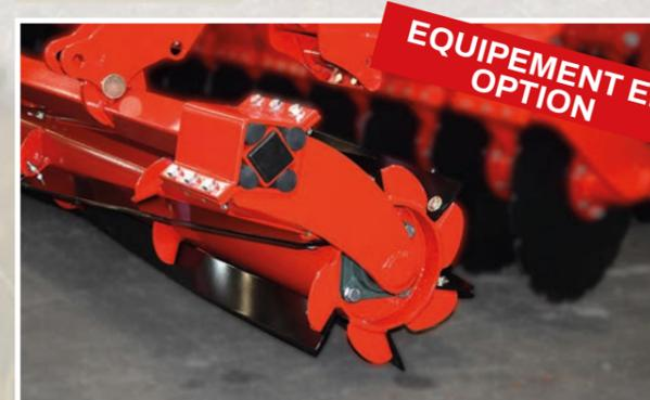
Le montage d'un Top-Cutter devant les disques de votre Disc-Roller XL Contour vous permet de broyer finement et d'incorporer les résidus végétaux.
