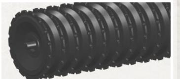
Die V-Profil-Packerwalze mit Ø600 mm sorgt für eine optimale Durchtrennung der Oberfläche und hinterlässt eine ideal rückverfestigte und vor allem witterungsbeständige Oberfläche. Das V-Profil ist ein gezahnter Ring aus gepresstem Stahl mit Schulterprofil, der für aggressive Zerkleinerung der Erdklumpen auf schweren Böden und eine optimale Rückverfestigung von leichteren Böden sorgt. Es gibt Schaber zwischen den Ringen, die unter allen Bedingungen eine wirksame Rückverfestigung gewährleisten.
