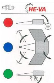
Indikationsmærkater til maskinens hydrauliske systemer:
