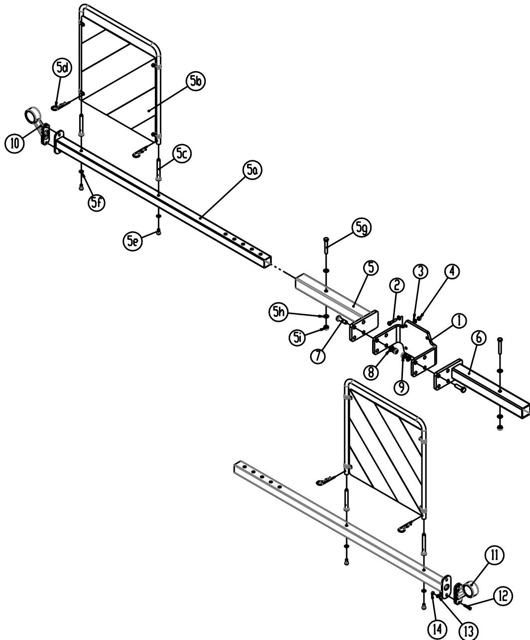
**Bemærk:** Pos. 5a kan justeres til uanset hvilken type godsstørrelse maskinen er monteret med.
