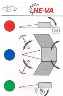
Indikationsaufkleber für die Hydrauliksysteme der Maschine.
