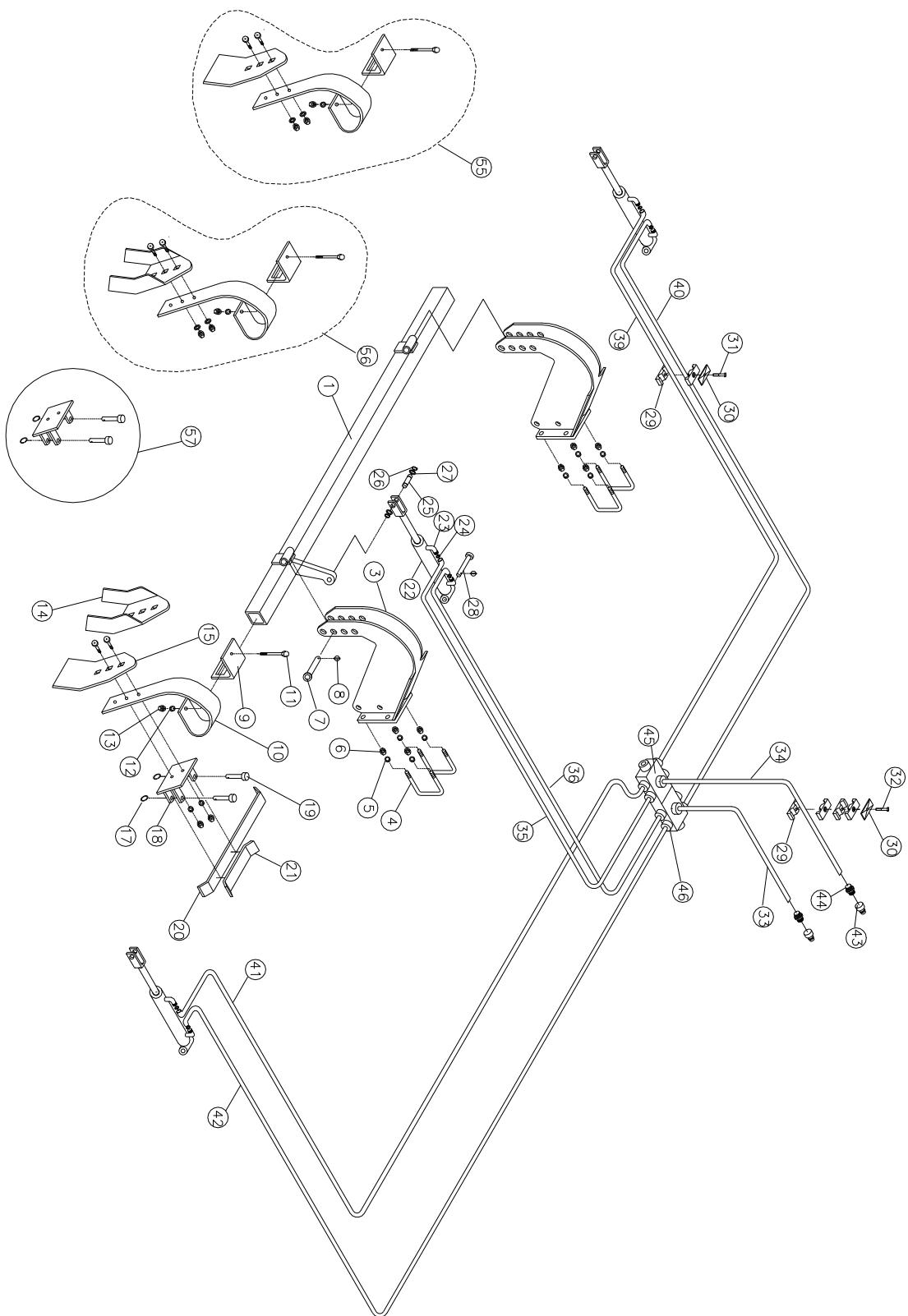
**Spring-Board Seitensegment 4,0 – 5,0 und 6,0m (hydraulisch)**
