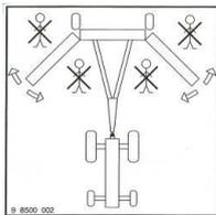
Immer dafür sorgen, dass sich keine Menschen in dem Gefahrenbereich der Maschine während der Aus- und Einklappen befinden.
