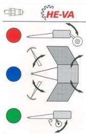
Indikationsaufkleber für die Hydrauliksysteme der Maschine:
