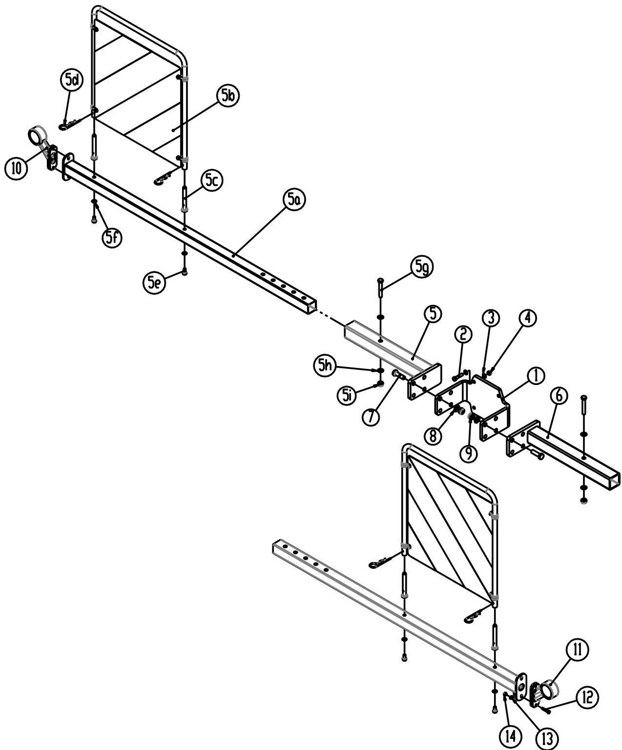
**Hinweis:** Pos. 5a ist einstellbar, unabhängig von der Art der Gutgröße, mit der die Maschine ausgestattet ist. Für hydraulische Modelle ohne Spring-Board oder Front-Egge
