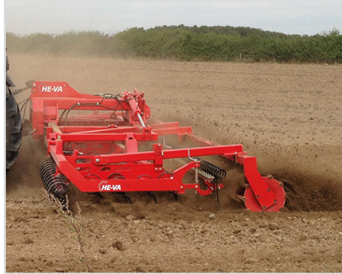
7,50 m aufgehängter Terra-Dan MKII mit schwerer Rohrwalze
