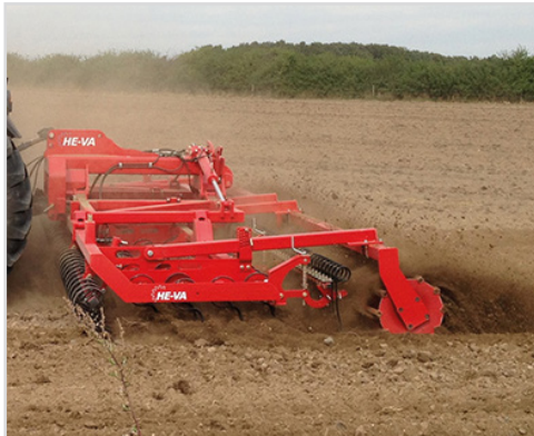
7,50 m lyftburen Terra-Dan MKII med rövvals med fyrkantströr.
