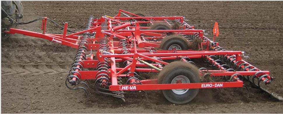
Euro-Dan Eco 8,00m m/forharv, Spring-Board planerplanka, Spring-Board efterharv och långfingerefterharv.
