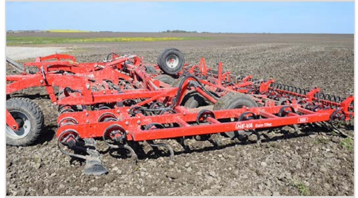
9,00 m Euro-Tiller mit 65x12 mm Zinken, mit Spring-Board, zusätzl. Reihe 65x12 mm Zinken, Spring-Board-Striegel, Striegel und Frontstützräder.
