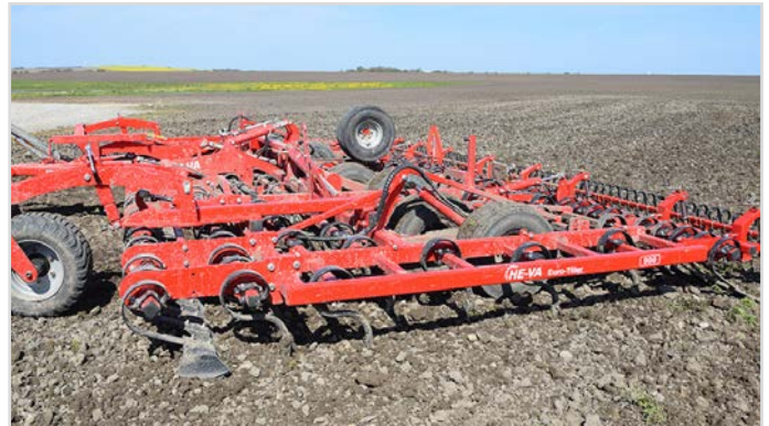
9,00 m Euro-Tiller m/65x12 mm tænder m/Spring-Board, ekstra række 65x12 mm tænder, Spring-Board-efterharve, langfinger-efterharve, og frontstøtkehjul.
