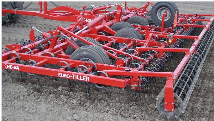
8,00 m Euro-Tiller m/Spring-Board planerplanke, fladjernsvalse inkl. langfinger- efterharve og reservehjul
