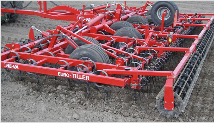
8,00 m Euro-Tiller m/ Spring-Board plank, vals inkl. långfinger-efterharv och reservhjul.
