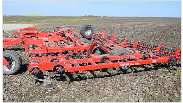
9,00 m Euro-Tiller m/65x12 mm pinnar m/Spring-Board, extra rad 65x12 mm pinnar, Spring-Board bak, långfinger-efterharv, och stödhjul fram.
