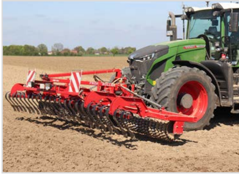
3,00 m Front-Roller Twin m/Ø550/550 mm Stjärnring.
