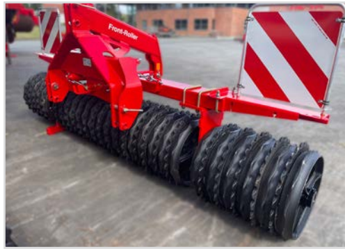
Rouleau frontal auto-directionnel avec articulation libre
