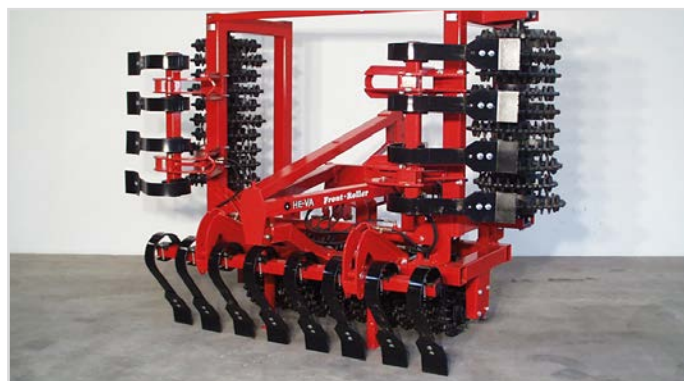
4,0 m Front-Roller avec Cross-kill Repliage hydr. et Spring-Board
