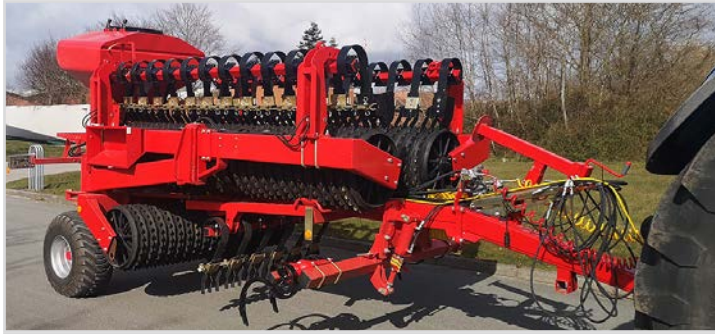
Sammenklappet Tip-Roller med Multi-Seeder, Spring-Board og sporløser
