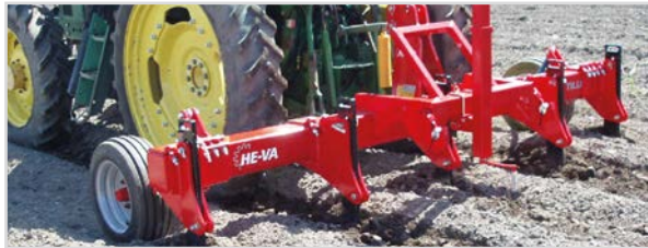
3,00 m Combi-Tiller MKI porté adapté sur un Disc-Roller Contour 3,0 m porté
