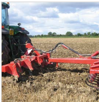
Combi-Tiller MKI attelage 3-points pour adaptation sur autres outils portés ou semi-portés. Compatible avec par exemple un butteur pour pommes de terre ou un semoir traîné
