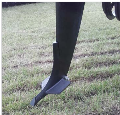
Easy-Draft kit. 15 mm tand m/120 mm slidspids med hårdmetalplatte.
