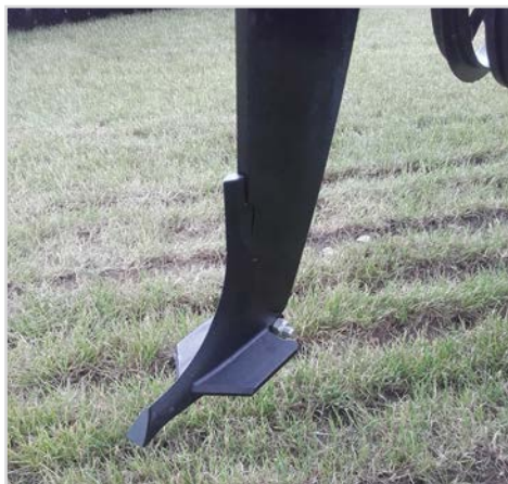
Kit de percement Easy-Draft. Dent 15 mm av/plaque renfort en carbure en 120 mm.
