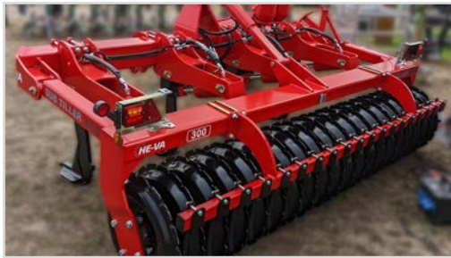
3,00 m med hydr. auto. udløser, 4 tænder, V-Profilvalse og hydr. dybderegulering
