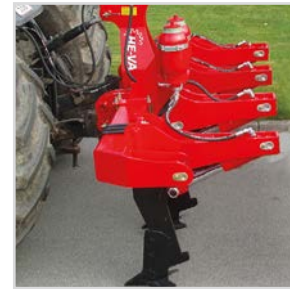
3,00 m med hydr. auto. udløser og 4 tænder
