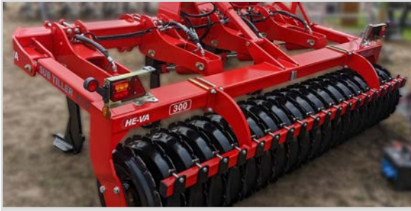
3,00 m Sub-Tiller avec sécurité hydr. automatique, 4 dents, rouleau V-Profil et réglage hydr. de la profondeur
