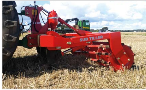
3,00 m Sub-Tiller avec sécurité hydr. automatique, 4 dents, rouleau V-Profil et réglage hydr. de la profondeur
