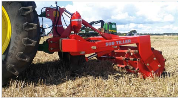
3,00 m m/hydr. Steinsicherung, 4 Zinken, V-Profilwalze und hydr. Tiefenregelung.
