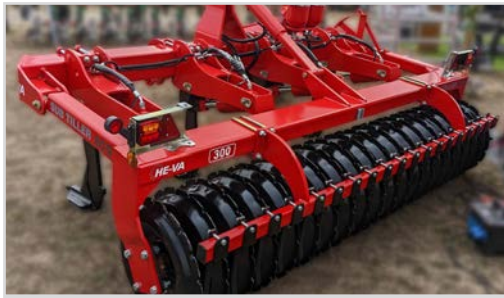
3,00 m m/hydr. Steinsicherung, 4 Zinken, V-Profilwalze und hydr. Tiefenregelung.
