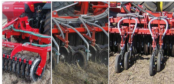
Skiveskærs-såning (12 cm ml./skiveskær) med 75mm brede dybdehjul / pakkervjul. Placeret i 2 rækker pr. tand. En række på hver side af grubbesporet efter pakkervalse.
