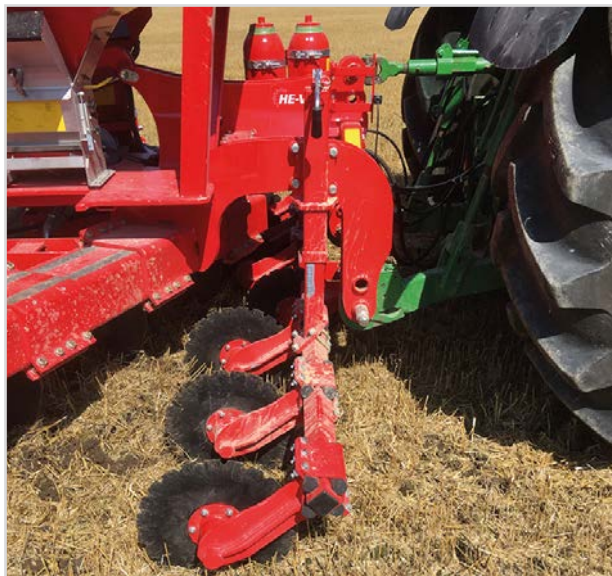
Ramme for rulleskær med rulleskær Ø470 mm.
