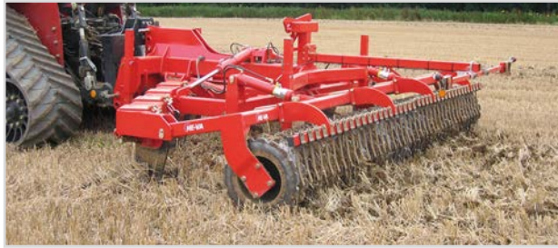
5,00 m Sub-Tiller med V-profilringe og hydraulisk automatudløser
