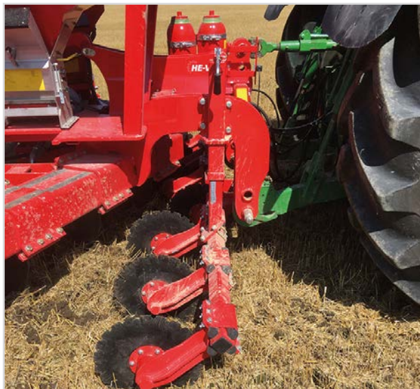
Ram för rullskär med rullskär Ø470 mm.
