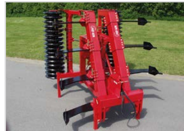
4,00 m Sub-Tiller m/hydr. ihopfällning, 7 pinnar, m/V-profilvals och Quick-Push
