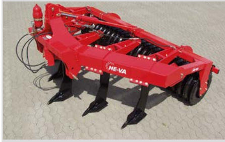
3,00 m rigide, 5 dents, avec anneaux V-profil et sécurité hydraulique automatique
