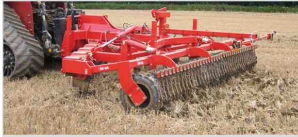
Sub-Tiller 5,00 m avec anneaux V-profil et sécurité hydraulique automatique
